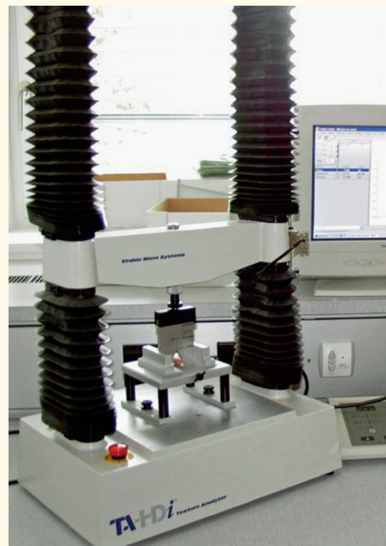
Figure 1 | Appareil pour mesurer la force de cisaillement. Dix carottages sont effectués après cuisson pour établir une valeur moyenne par animal.
